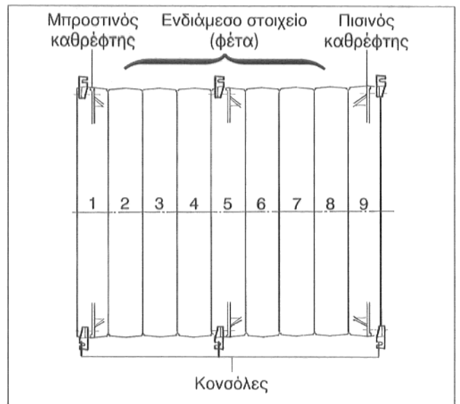
Εικ. 27, όψη από πάνω, 9-μελές μπλοκ λέβητα, με κονσόλες
